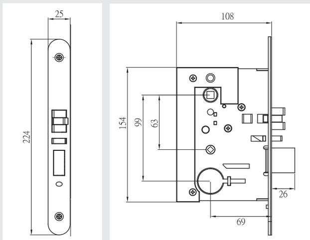
Корпус замка выполнен в соответствии со стандартами ANSI. Изготовлен из высококачественной нержавеющей стали марки SUS304. Фронтальная планка 224 X 25 мм с закруглёнными краями.
